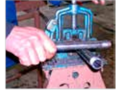
Diş üzerindeki çapakların temizlenmesi
